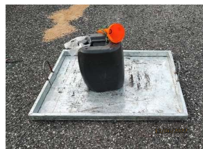
รูปที่ 2-23 ที่รองรับน้ำมัน ถาดรอง และวัสดุดูดซับ
