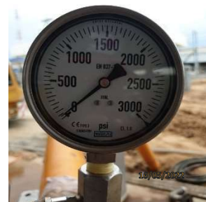
รูปที่ 2-29 การปรับลดแรงดันจากการทดสอบท่อด้วยวิธี Hydrostatic Test
